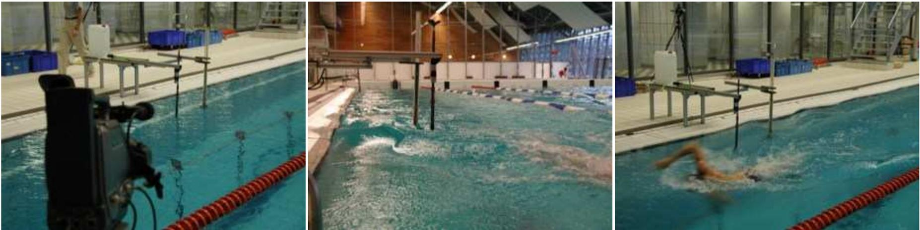
Para medir a altura da onda utilizou transdutores de pressão e uma escala colada a uma vara.
